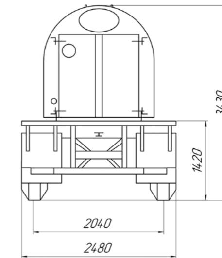
Полуприцеп-цистерна ЦЖУ - 18,0 - PS24Р. Габаритный чертеж.
