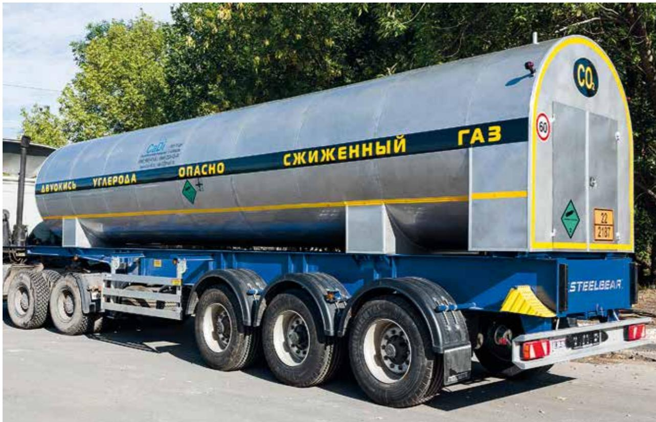
**Полуприцеп-цистерна для транспортировки жидкой двуокиси углерода ЦЖУ-18.**
